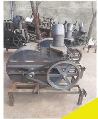
دستگاه مکنده کاه ( کاه پر کن ) مدل **TAKSA ۷۰** ساخت شرکت توسعه کشاورزی سهیل اکباتان ( تکسا ) است که جهت جمع آوری کاه خرد شده در مزرعه ( توسط کمباین کاه کوب ) و انتقال آن به انبار مورد استفاده قرار میگیرد . این دستگاه به عنوان یک وسیله ثابت زراعی بوده ، با دریافت نیرو از محور **PTO** تراکتور عمل جمع آوری کاه خردشده را انجام می دهد .
